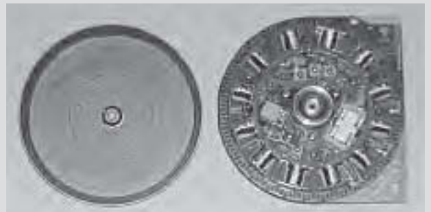
Figure 12.16 Moteur Brushless de lecteur de disquette à faible encombrement, à aimants permanents, rotor extérieur en chapeau et flux radial.
