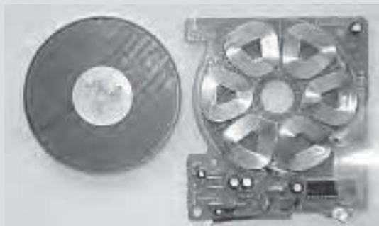
Figure 12.17 Lecteur de disquette à aimants permanents et flux axial. Moteur hexapolaire. Rotor disque.
